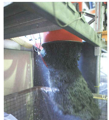
Wenn die Fräsanlage stoppt, öffnet sich eine Klappe im Boden des Zyklonabscheiders und die Späne fallen in eine Gitterbox
